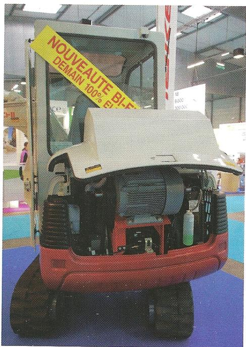
même manière que leurs aînées (TB016, TB125, TB135). La seule différence tient au poids, la version « bi-énergie » pèse, en effet, environ 200 kg de plus que les versions thermiques. Le constructeur travaille en parallèle sur une version 100% électrique (prototype présenté à Intermat 2006), un outil adapté pour les travaux à l'intérieur des bâtiments.
